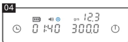
抽出器具をスケールから取り除くと、タイマーが止まり、ディスプレイには抽出時間と注湯量が表示されます。追加で抽出したい場合は、抽出器具をスケールの上に戻しタイマーボタンを短く押すとタイマーと重量表示が再開します。再びタイマーボタンを短く押すとタイマーは止まります。タイマーボタンを長押しするとディスプレイがクリアされ、次の抽出が行えます。
