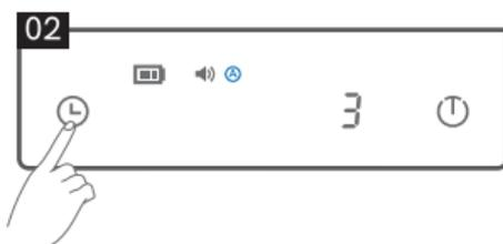
スケールの上に抽出器具をセットし、挽き豆をフィルターに入れます。タイマーボタンを短く押します。「3、2、1」とカウントダウンが表示されます。
