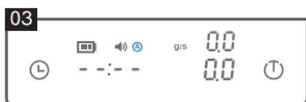
カウントダウンが終了すると、時間は「-: -」と表示され、重量は「0.0」と表示され、抽出を開始できます。お湯を注ぐとスケールが重さを感知し、タイマーがスタートします。（タイマーが40秒を超えると、計測データが有効になります。）
